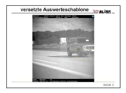
In einem der bisher bekanntesten Extremfälle liegt die Auswerteschablone auf dem Hinterrad eines Fahrzeuges.
